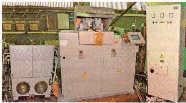
Рис. 1. Сварочная машина МСО-750 с гидростанцией и шкафом системы управления
