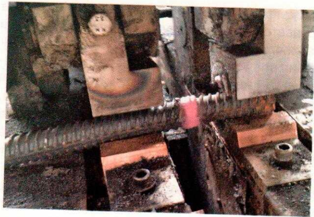
Рис. 2. Узел сварочных электродов машины МСО-750 со вставками после сварки и зачистки грата
