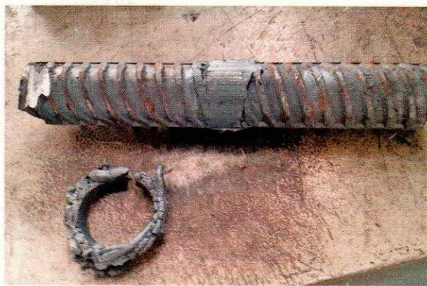
Рис. 3. Вид сварного стыка арматуры диаметром 25 мм и срезаемого грата после зачистки
